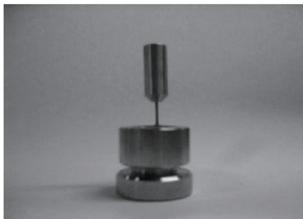
カソードに試料をセットする際に使用する治具とプレスピン
